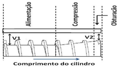
Figura 7. Representação do modelo de processo de prensagem baseado em zonas de compressão.
