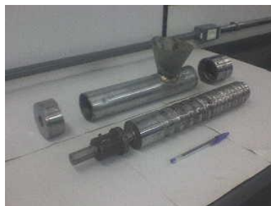
Figura 12. Fotos do protótipo de prensa extrusora: (a) eixo helicoidal com duas entradas de rosca; (b) Componentes da extrusora - suportes de entrada e saída do eixo e câmara de compressão com funil.
