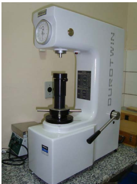
Figura 4. Durômetro Rockwell Durotwin – 963 – 102 R.
