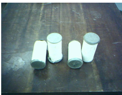
Figura 5. CPs “capeados” para os ensaios de compressão.
