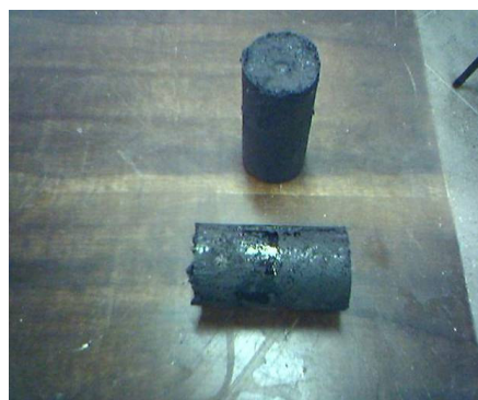
Figura 8. CPs após a impermeabilização.
