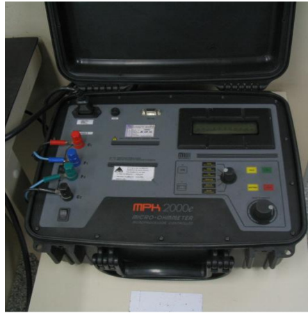
Figura 6. Multiohmímetro (Ponte de Kelvin) MEGABRÁS modelo MPK-2000.
