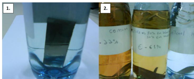
Figura 10. Amostra dentro de recipiente com 350 ml de álcool hidratado (1), três recipientes com E22, E61 e AEHC (2).
