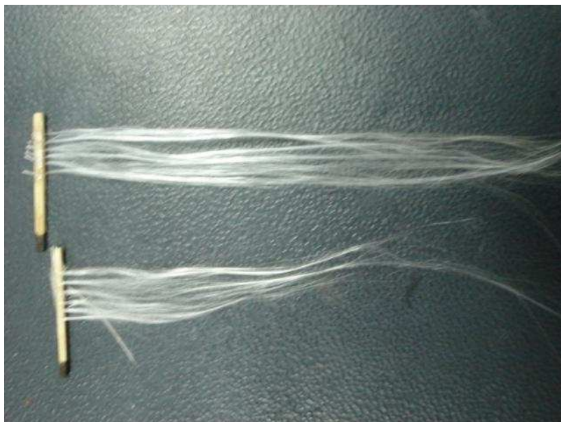
Figura 6. Fotografia das fibras de vidro após ensaio de tração.
