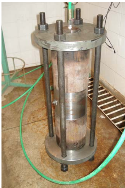
Figura 5 – Corpo de Prova, teste hidrostático do MR
