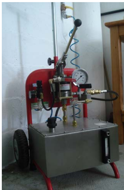
Figura 6 – Equipamento para testes hidrostáticos
