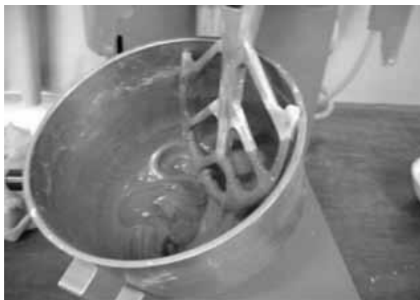
Figura 3. Misturador utilizado para o processamento das massas de concretos.
