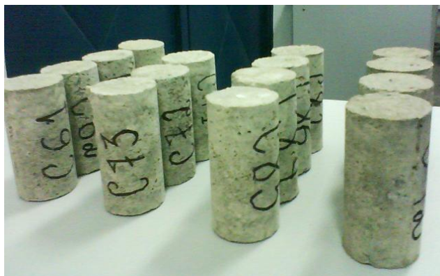
Figura 2. Corpos de provas de concreto moldados em forma cilíndrica.
