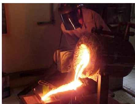
Figura 2. Vazamento do aço líquido em molde de areia.
