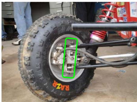
Figura 7. Exemplo de como o pino mestre foi alojado na roda. Nota-se claramente que as articulações da manga de eixo ficam no interior da roda.
