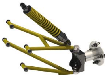
Figura 5. Detalhe do sistema de suspensão do tipo Duplo “A”. O modelo foi desenvolvido em CAD (SolidWorks®), durante o desenvolvimento do MiniBaja atual da UTFPR.
