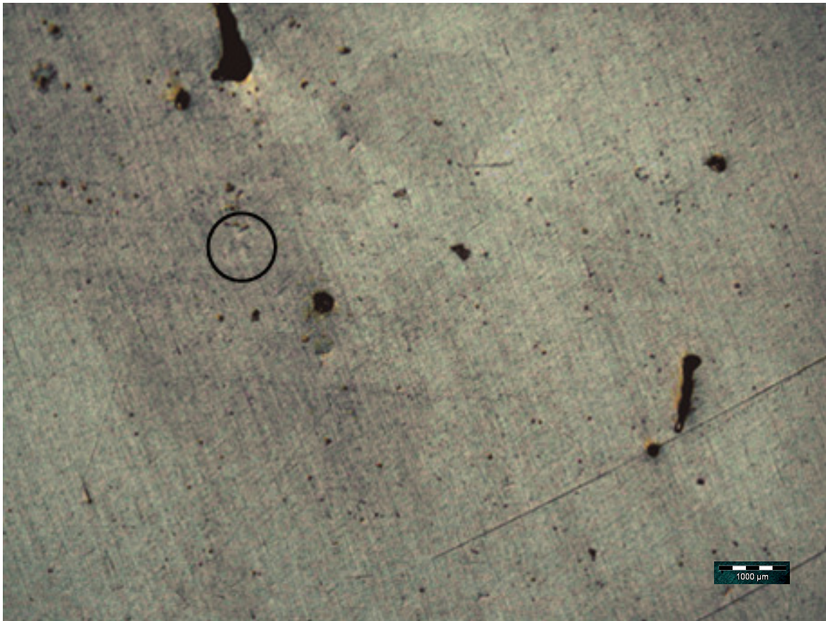
Figura 4- Microestrutura da liga Al-1,5%Si-1,0% Cu tratada a 120°C por 60 minutos
