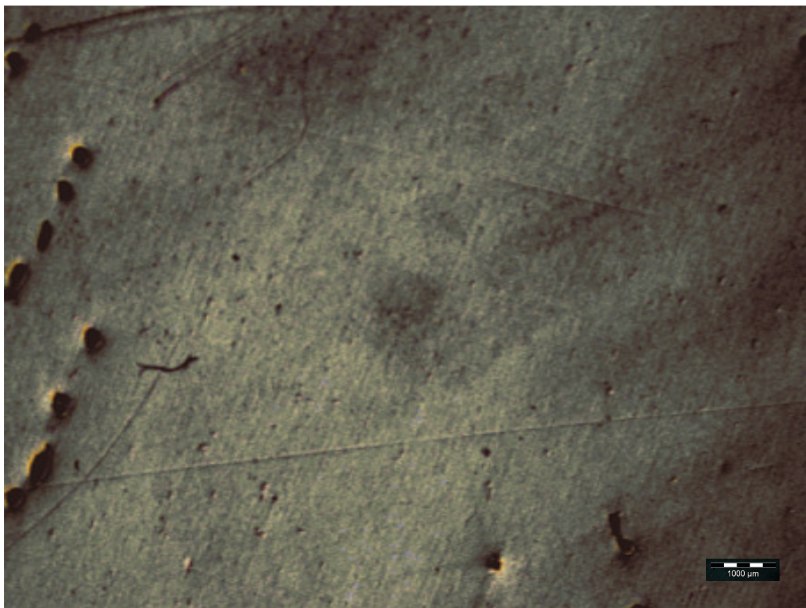
Figura 3- Microestrutura da liga Al-1,5%Si-1,0%Cu tratada a 120°C por 5 minutos
