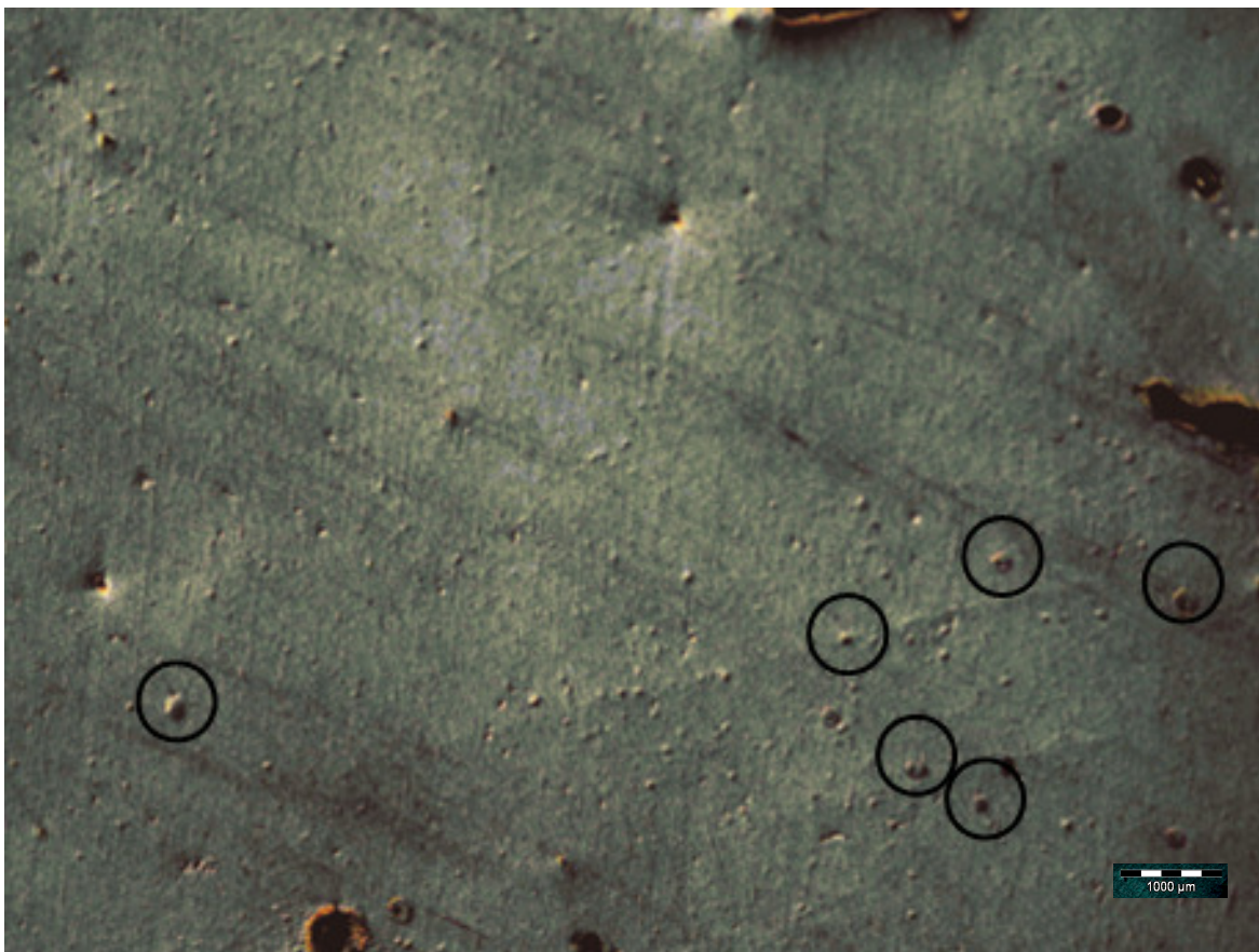
Figura 5- Microestrutura da liga Al-1,5%Si-1,0% Cu tratada a 150°C por 5 minutos
