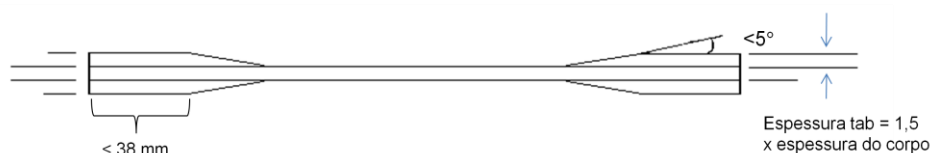
Figura 2. Corpo de prova para tração segundo a norma ASTM D3039-08
