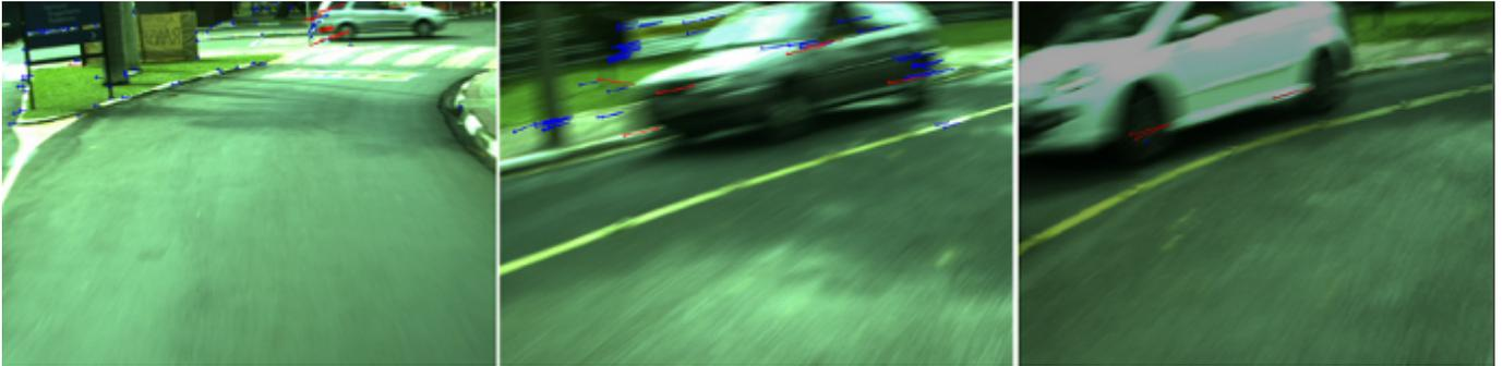
Figura 11: Automóviles. Objetos dinámicos reconocidos por el algoritmo a pesar de que la imagen aparece borrosa debido a la velocidad de los objetos presentes.
