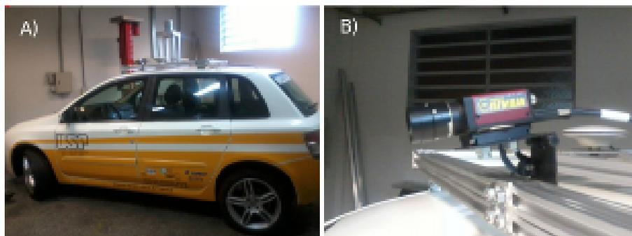
Figura 1: A) Vehículo donde se realizaron los experimentos B) Cámara monocular Infaimon Stingray
