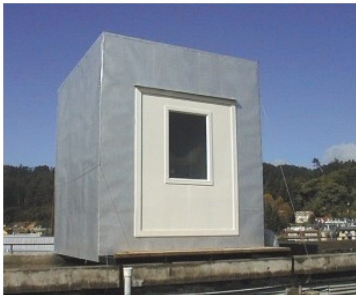
Figura 4 : Cámara de ensayos instalada sobre edificio
