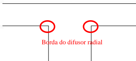
Figura 10 - Ilustração da borda do difusor radial (canto vivo).
