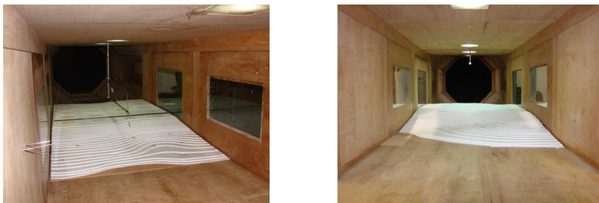
Figura 3. Modelos de 0° e 30° na câmara de testes do túnel de vento.
