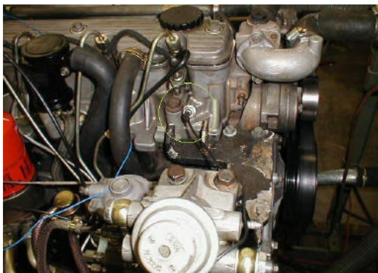
Figura 3: sensor de pressão instalado no cilindro nº 1 do motor (FEITOSA, 2003).
