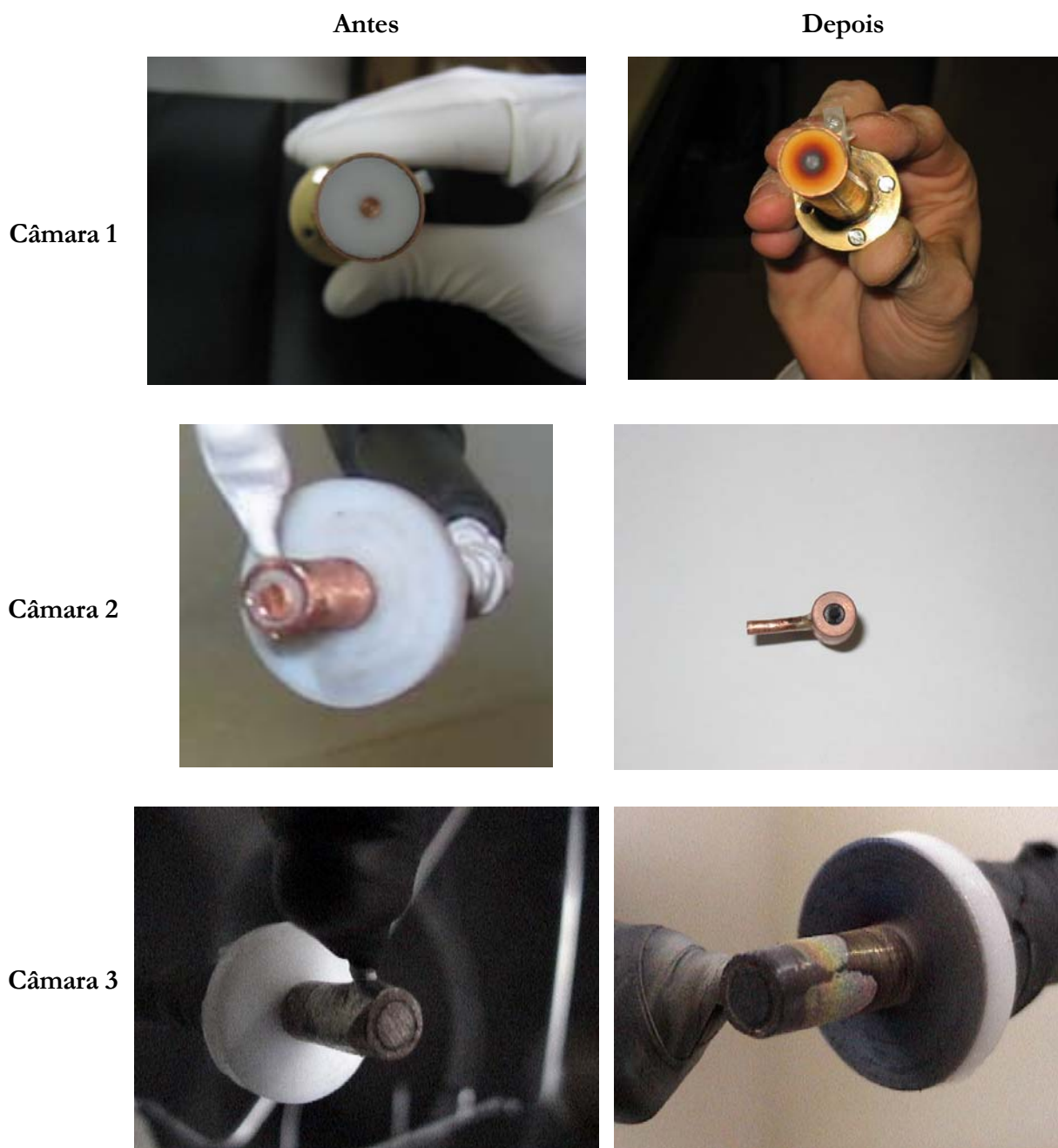
Figura 7. Aspecto das câmaras de descarga antes e depois dos testes.
