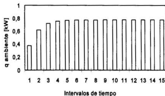
Figura 9 - Flujo de calor disipado al ambiente por intervalo de tiempo ( \Delta t=60 s)
