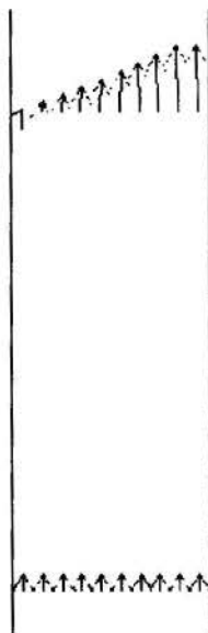
Figura 3 - Perfil de velocidade na base e no topo da coluna de absorção.
