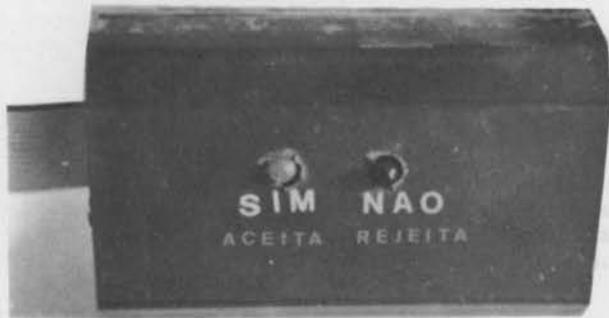
Fig. 8 - Painel que indica se a peça foi aceita ou rejeitada; o sinal é proveniente do conversor D/A.
