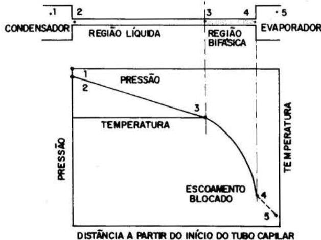
Fig. 1 - Distribuição de pressão e temperatura ao longo de um tubo capilar.
