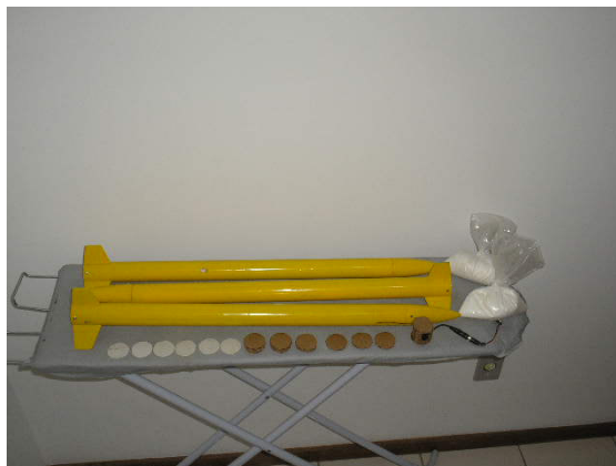
Figura 9: Fuselagens com acabamento, separadores dos componentes, sistemas de vídeo e nitrato de potássio
