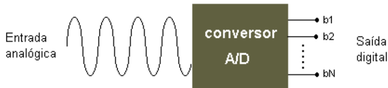
Figura 3: Conversão de um sinal analógico para um sinal digital.
