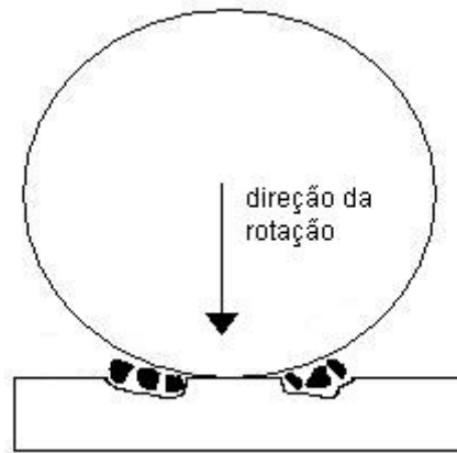
Figura 2: Formação de “pico” devido à utilização de esfera polida; adaptado de (Allsopp et al. 1998).
