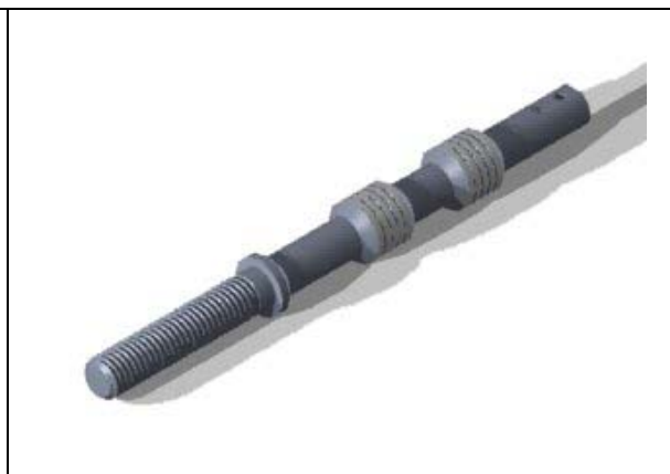
Figura 1b – Carretel do sensor hidráulico de velocidade
