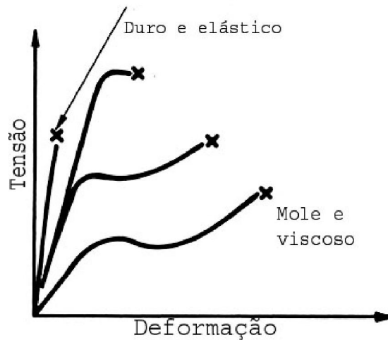
Figura 1: Diferentes comportamentos Tensão-Deformação que um material polimérico pode apresentar pela variação da temperatura ou taxa de deformação.
