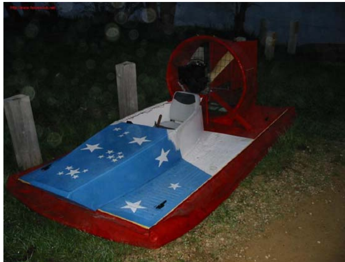
Figura 3: UH-10F, usado como base para o dimensionamento do projeto (Universal Hovercraft of America, 2006).
