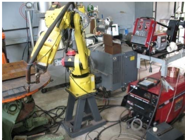
Figura 3: Fonte, robô e mesa de soldagem.
