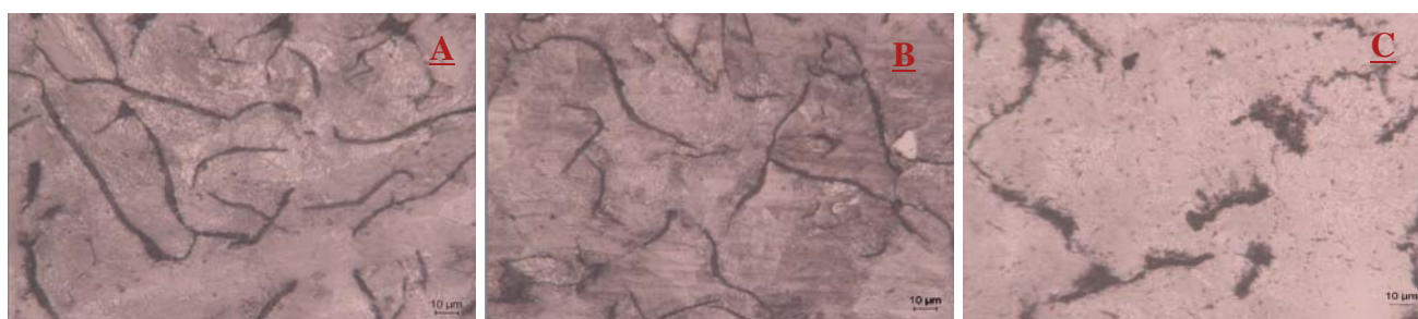
Figura – 3. Microestrutura dos materiais A, B e C atacados com a 3% de Nital, ampliação de 400x.
