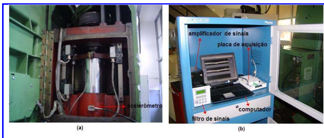
Figura 2 – (a) acelerômetro fixado no mancal do eixo-árvore da máquina-ferramenta. (b) sistema de aquisição dos sinais de potência e vibração.
