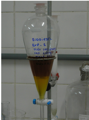
Figura 3.3. Decantação da glicerina e do biodiesel
