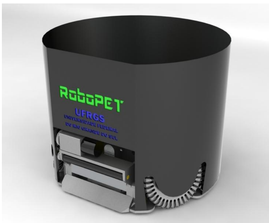
Figura 7.1. Robô montado revestido pela capa de PET adotada no novo projeto.
