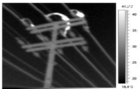
Figura 5 – Leitura emitida em escala monocromática pelo termovisor da AGEMA, série 400 (Moura, 2008).
