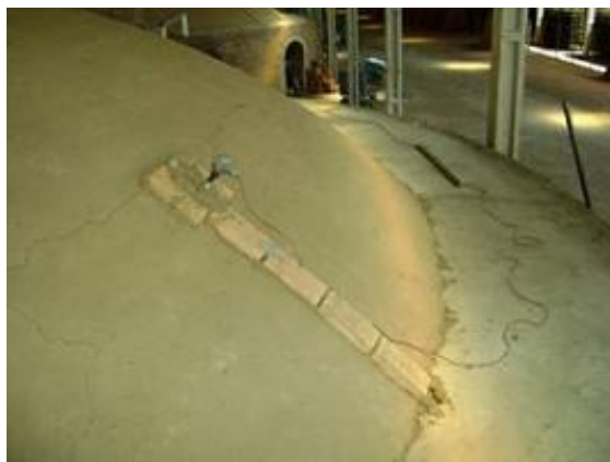
Figura 2. Parte superior do forno abóboda onde é mostrado o isolante térmico aplicado
