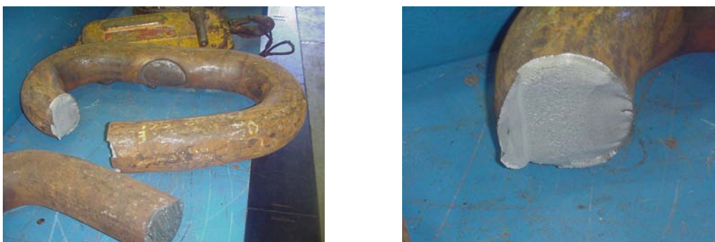
Figura 3. Detalhe do elo 2 após ensaio de fadiga, rompido em 55.000 ciclos.
