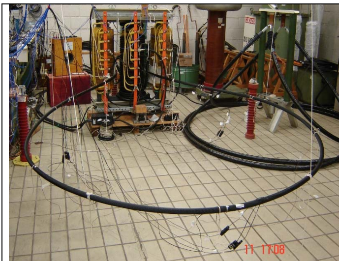
Figura 3.a. Arranjo experimental para medições de temperatura interna e externa para um cabo Tern pintado com tinta preta fosca de emissividade conhecida, \epsilon = 0.95 .
