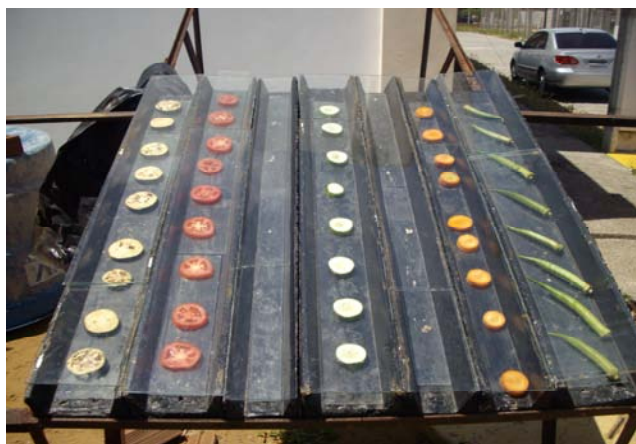
Figura 1. Sistema de secagem proposto em teste.
