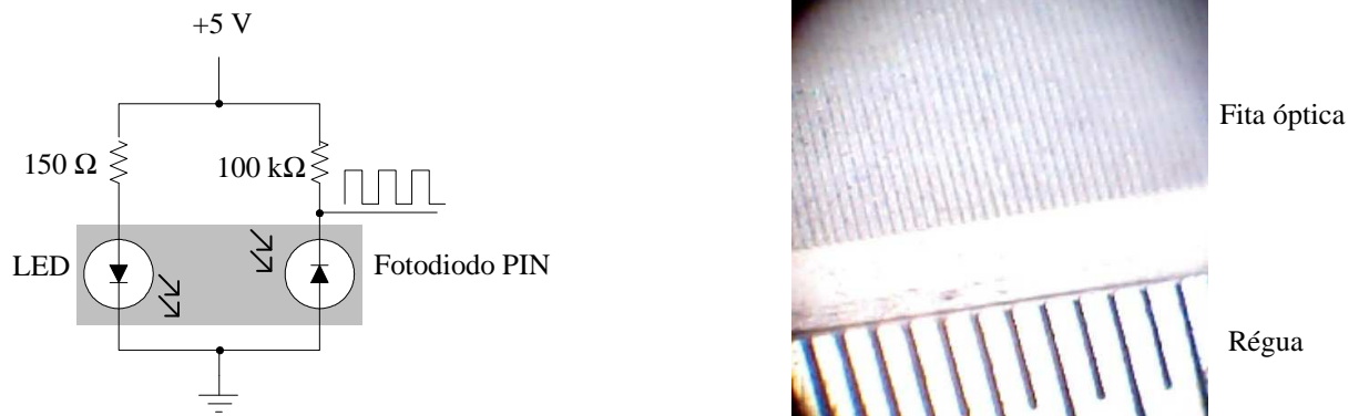
Figura 4. (a) Circuito do sensor óptico. (b) Fotografia da fita óptica ao lado de uma régua com escala em milímetros.
