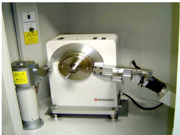
Figura 3 – Difratorômetro de raios-X modelo Shimadzu XRD 6000 Fonte: pesquisa direta, 2009
