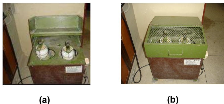
Figura 2 – Moinho de bolas [(a) posicionamento dos recipientes (b) em funcionamento]
