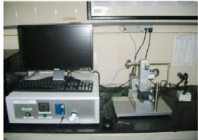
Figura 4: Ilustração do equipamento de microabrasão: a) Esquema do funcionamento do ensaio; b) Figura ilustrativa do equipamento.
