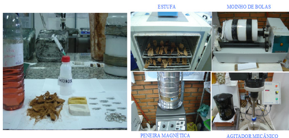
Figura 4. Materiais - lado esquerdo (resina poliéster, fibras de coco, iniciador, fôrmas de silicone, adesivos e argolas). Equipamentos – lado direito (estufa, moinho de bolas, peneira magnética e agitador mecânico).
