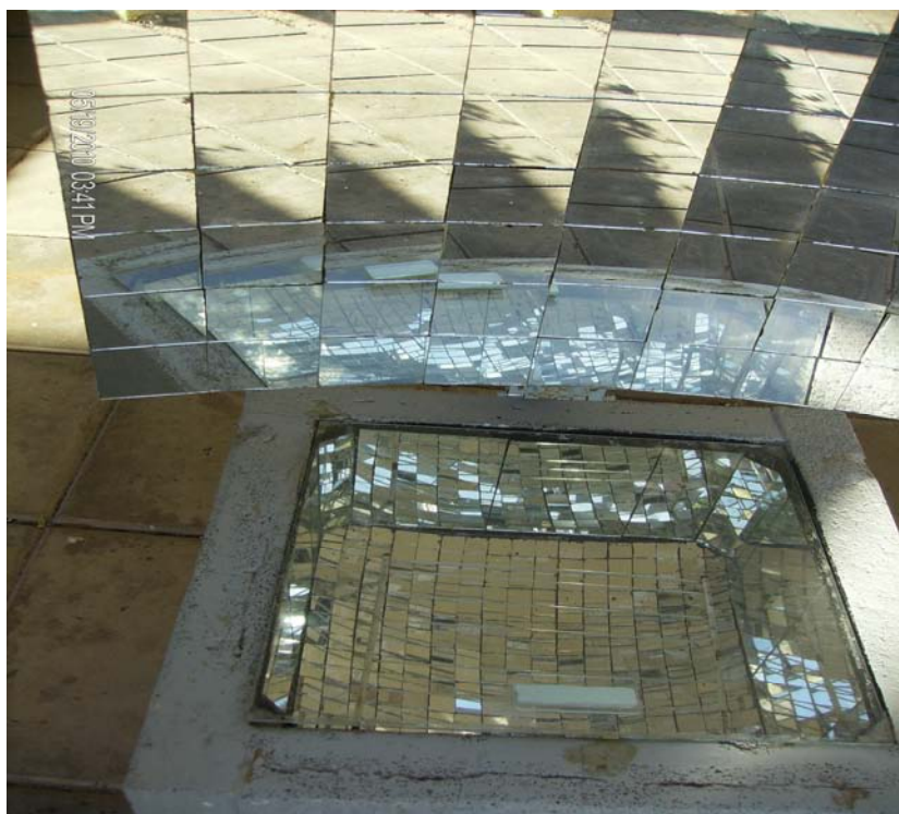
Figura 6. Forno/fogão solar proposto com espelhos nas laterais em teste.
