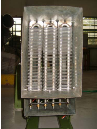
Figura 5. Conjunto de resistências com 3 kW de potência.
