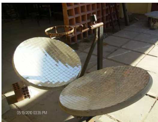
Figura 6. Fogão solar com duas parábolas.
