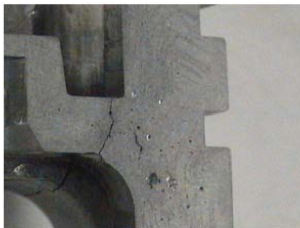
Figura 11. Defeitos encontrados no interior do material da peça.
