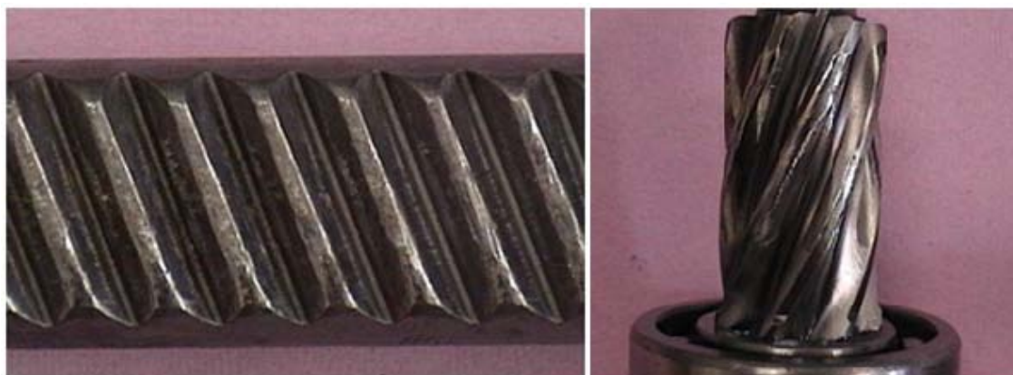
Figura 2. Vista de parte da cremalheira e do pinhão mostrando o amassamento e a retirada de lascas da superfície dos dentes.
