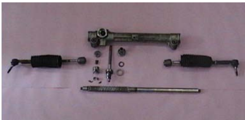
Figura 1. Setor após ser desmontado e limpo para início das análises.
