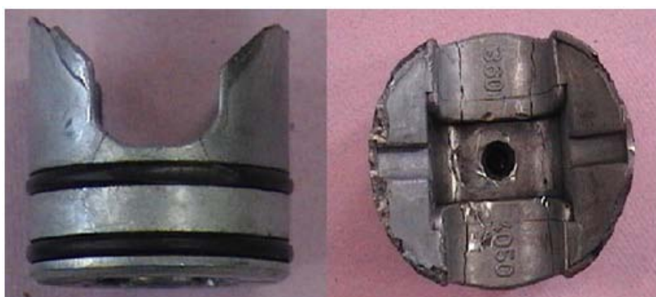
Figura 3. Trincas paralelas encontradas na peça de ajuste da folga pinhão cremalheira.
