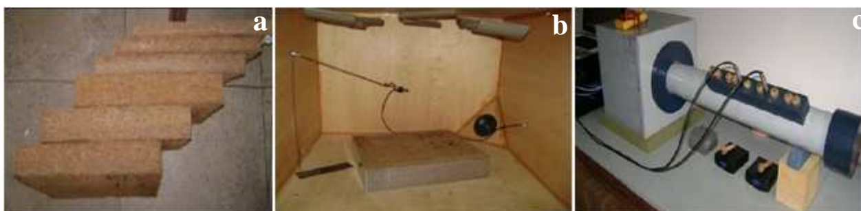
Figura 1 - (a) Painéis industriais de fibra de coco de diferentes espessuras e densidades ensaiados em (b) câmara reverberante e (c) em tubo de impedância.
