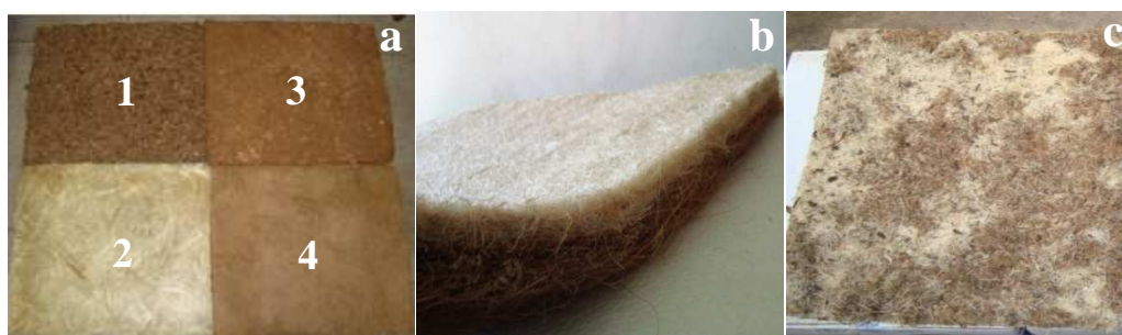
Figura 2 - (a) Painéis artesanais de fibras de (1) dendê, (2) sisal, (3) açaf e (4) coco, (b) painel multifibras de coco/sisal e (c) painel mesclado de dendê/sisal.
