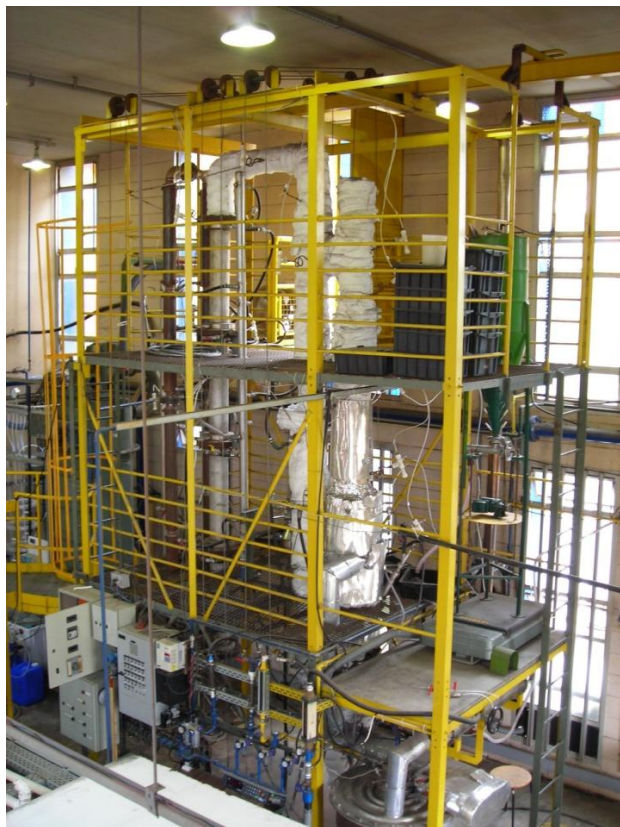
Figura 1: Combustor de Leito Fluidizado Circulante. Figura 2: Esquema do circuito principal LFC.
