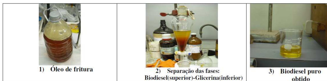
Figura 7. Obtenção do Biodiesel a partir do óleo de fritura coletado no Restaurante da USP.
