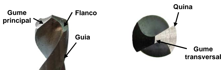
Figura 5. Geometria da ponta da broca de aço rápido.
