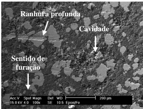
Figura 15. Microestrutura da resina epóxi/Fe na metade do furo com aumento de 100x. Resina com 30% de carga metálica e v_c 100 m/min.
