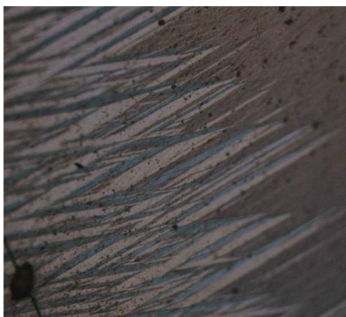
Figura 7. Micrografia da liga Cu-Zn-Al resfriada (fase martensítica). Aumento de 200x.
