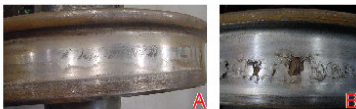
Figura 2: Defeitos em rodas ferroviárias, A - superfície martensítica causada por escorregamento, B – “shelling” (escamação) (Clarke, 2008).
