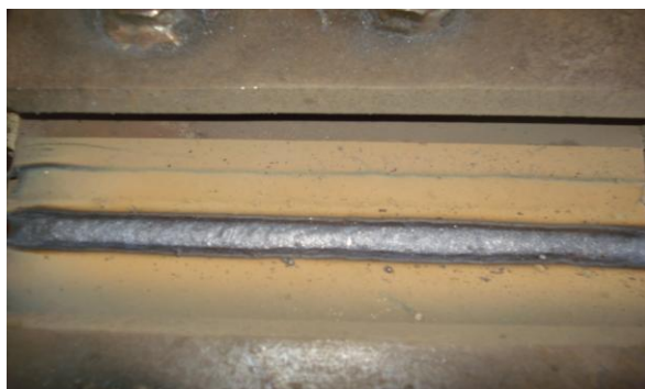
Figura 1. Cordão de solda após soldagem.
