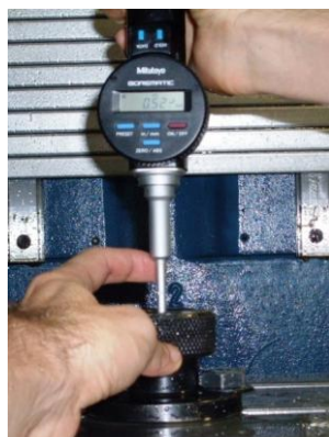
Figura 5. Medição dos furos sendo realizada com o equipamento Borematic da Mitutoyo
