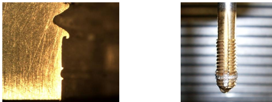
a) Falta de filetes.
